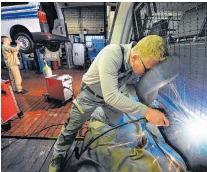
Sicher verwahrt: In der KFZ-Werkstatt baut Hauptwerkmeister Timo Reddehase Bullis zu Gefangenentransportern um.
